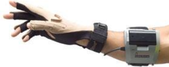
Abbildung 2.13 CyberGlove® II Datenhandschuh der Firma Immersion Corporation [Imm07]
